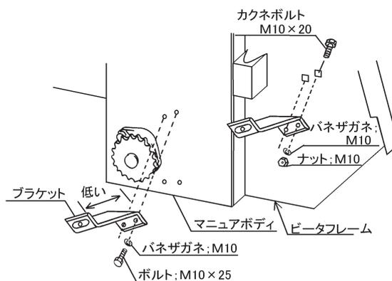
3. テンションローラのナットをゆるめ、ツギテの向きに注意してローラチェーンを掛けてください。カバーアッセを組んだとき、収まりが悪い場合は、ブラケットの取り付け位置を調整してください。
