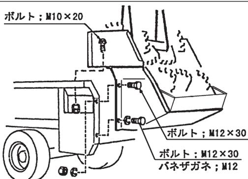
2. ブラケット2ヶのうち低い方のブラケットをマニュアルボディ側へ、高い方のブラケットをアタッチ側に組み付けてください。
