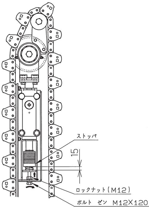
(6) ボルト、ロックナットを完全に固定します。
