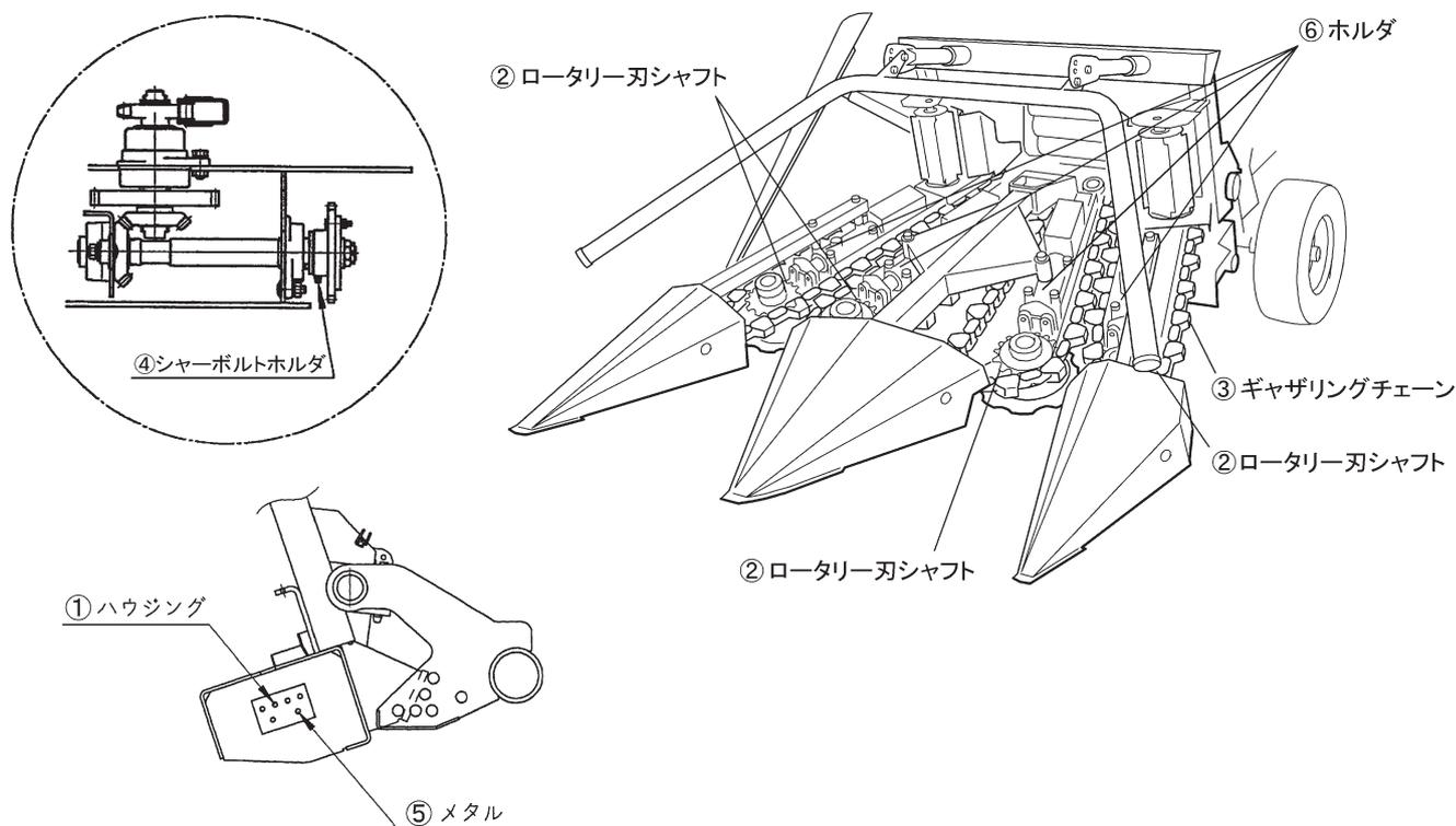
表のNo.1、2は塵芥、汁等の混入による軸受け部の寿命低下を防止するため、下記要領で入念に給油してください。
