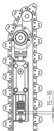
図示寸法が 15mm のとき適正なテンションです。
