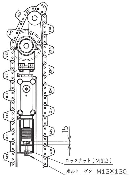
ギャザリングチェーンは60haを目安に交換してください。使用後の給油が十分でない場合、上記面積にいたらないで、チェーンピン部に異常なガタが発生することがあります。このときはただちにギャザリングチェーンを交換してください。
