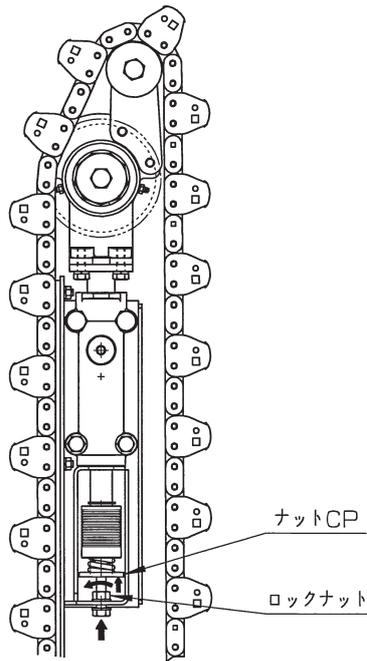
(5) ストップとナットCPの寸法（図示）が15mmとなるよう調整します。（15mmまで調整した後は、ロックナットを押さえ、ボルトを締めます。）
