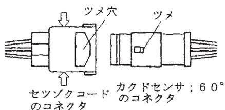
セツゾクコードには「右」と書かれたラベルが付いています。「右」と書かれたラベルが付いた2Pコネクタと3Pコネクタには進行方向に向かって右側の電動シャッタユニットに、ラベルが無い方は進行方向に向かって左側の電動シャッタユニットに取り付けてください。
