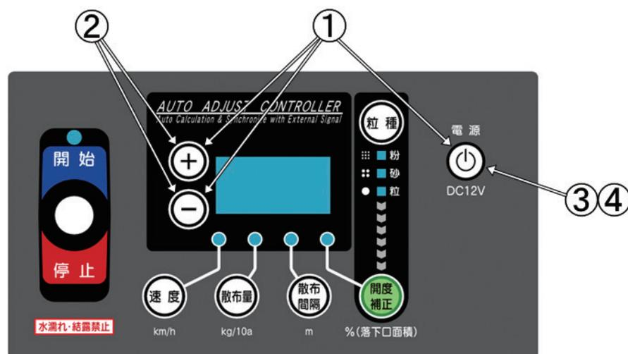
①「+」と「-」ボタンを同時に押しながら「電源」ボタン押し、「電源」ボタンを先に離した後、「+」と「-」ボタンを離して電源を入れてください。
