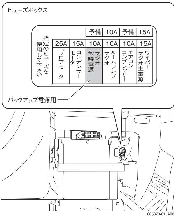
バックアップ電源の切り替えかた
