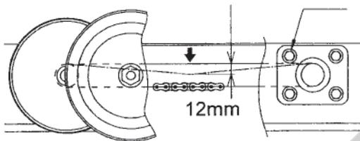
張りの強さはローラチェーンの中央部を指で押してたわみ量が 12mm になるのが適切です。
