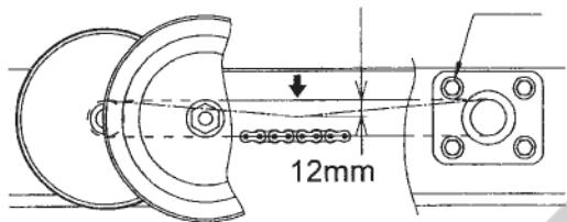
張りの強さはローラーチェーンの中央部を指で押してたわみ量が 12mm になるのが適切です。
