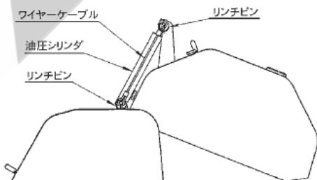
(5) 各部の点検・調整後は油圧シリンダ取付けピンからワイヤーケーブルを取り外し、ケーミング内に収納してください。
