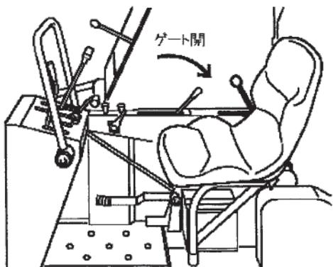
(7) ボールの排出が終わったら、ゲート開閉レバーを「ゲート閉」にしてゲートを閉めます。
