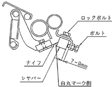
ロックボルトを1/2回転程度緩めてからボルトでナイフとシャバーのスキマがなくなるように調整してください。
