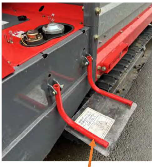
パイプの上にポリタンクを置く
