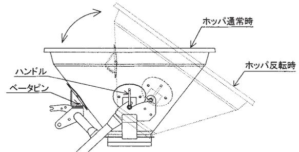
ホップは後方に倒すことによって反転し、容易に点検、清掃ができます。
