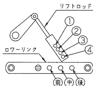
3点リンク最上時、シャッター開閉レバーがトラクタに干渉するものがあります。純正ロータリー用ヒッチ以外で本作業機を装着する場合は、リフトロッド穴を4（最下）、ローリンク穴を後で装着してください。
