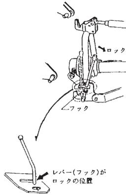
(10) PIC軸芯がトラクタ中心におおよそ一致するようにチェックチェーンでセットしてブロードキャスタの横振れをなくしてください。
