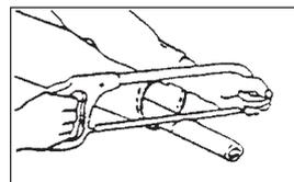
切断するときは、パイプの中にウエスを詰め、パイプ内面に切り粉が付着するのを防いでください。
