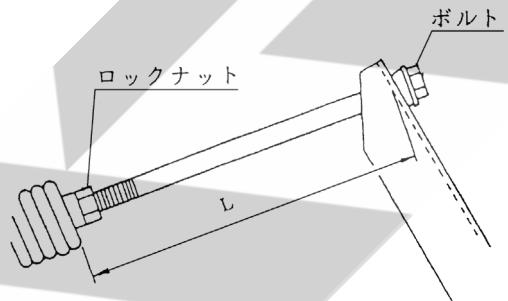
(2) 土手などののり面でカッタバーを水平位置から $30^\circ$ 以上下向きにして作業するときは、上記標準寸法より $50 \sim 100\text{ mm}$  (MDM 1750は $L=350 \sim 400\text{ mm}$ 、MDM 2150、2450は $L=280 \sim 330\text{ mm}$ )長くなるよう調整してください。
