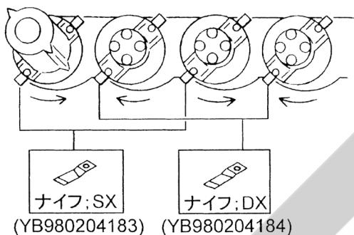
ナイフボルト、ナットを締付けるときは、ディスクに回り止めを当て、締付けトルク110～127N・m (=1100～1270kg・cm)でしっかりと締付けてください。
