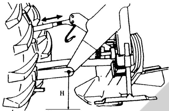
(2) のり面（傾斜面）の刈取作業のときは、ロワーリンクピンの地上高をカッタバーがのり面に添うように調整してください。
