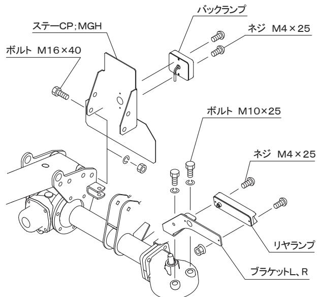
(7) リアランプ取付部のコードには、右ラベルがあります。機体進行方向と合うように組付けください。トラクタ側のコードが長い場合はリピートタイで結束してください。
