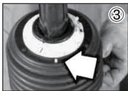
③アウターコーンを取付、コーンの穴にベアリングリングの基準ピンを挿入します。
