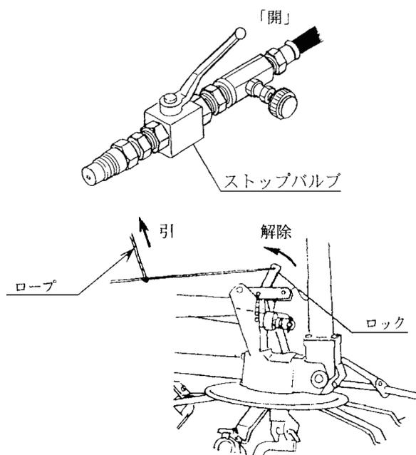
2. トラクタ油圧（外部取出）を操作し、ロータを広げてください。
