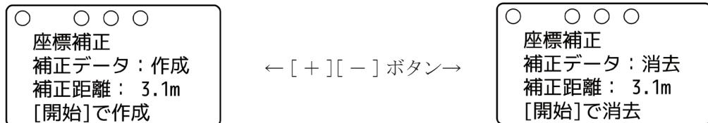
・作成モード（初期画面）で[開始]ボタンを押すと座標補正操作が実行されます。
