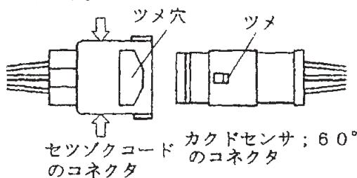
③セツゾクコード（電動シャッタ側）の2Pコネクタ（T字）とコード；3500（電源コード）またはトラクタ内の電源に取り付けてください。
