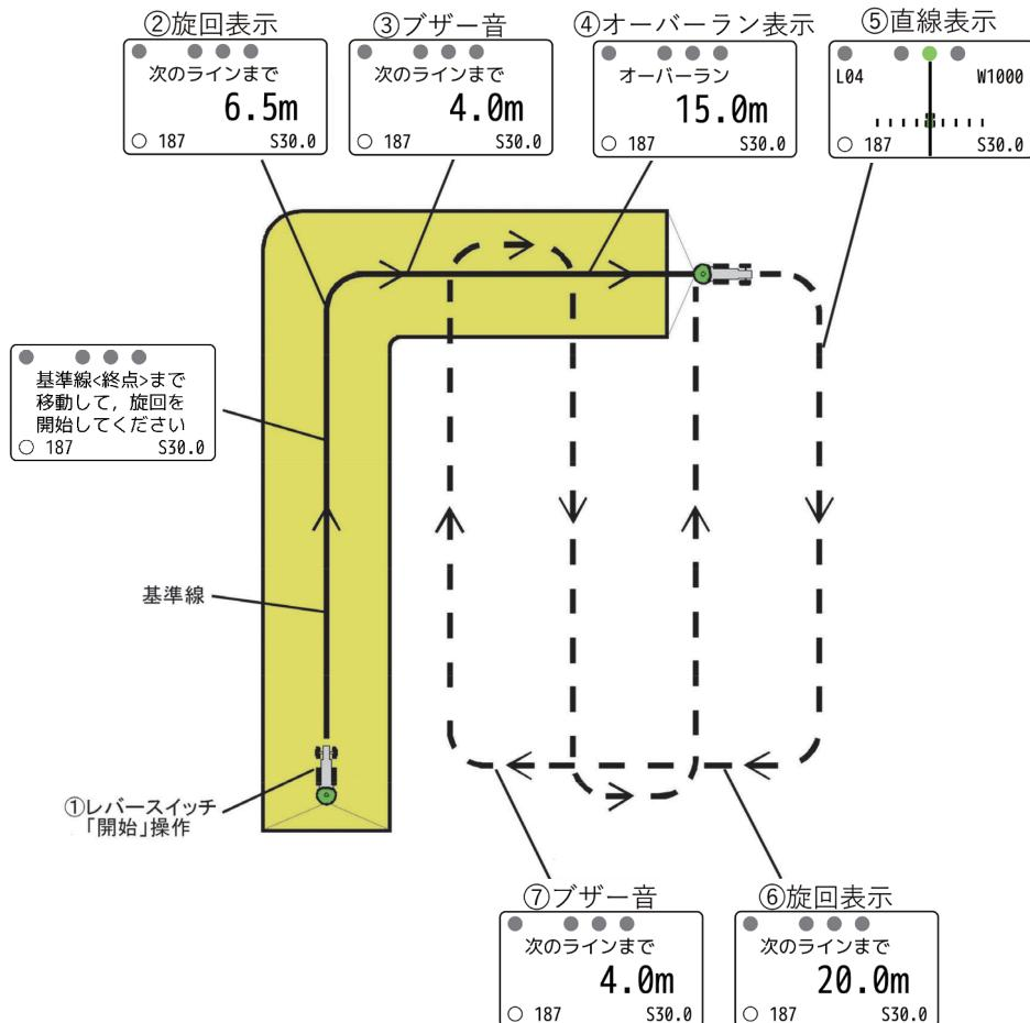
① コントロールボックスのレバースイッチを「開始」側に倒し、走行を開始してください。
