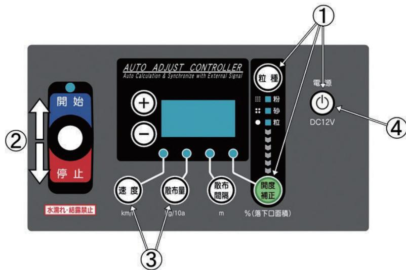
①「粒種」と「開度補正」ボタンを同時に押しながら「電源」ボタンを押し、「電源」ボタンを先に離した後、「粒種」と「開度補正」ボタンを離して電源を入れてください。
