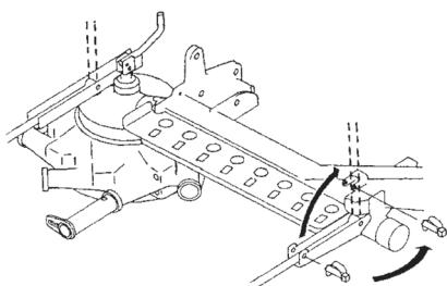
5. タインアームをロータより取り外し、フレーム側に差し替え、リンチピンで固定してください。
