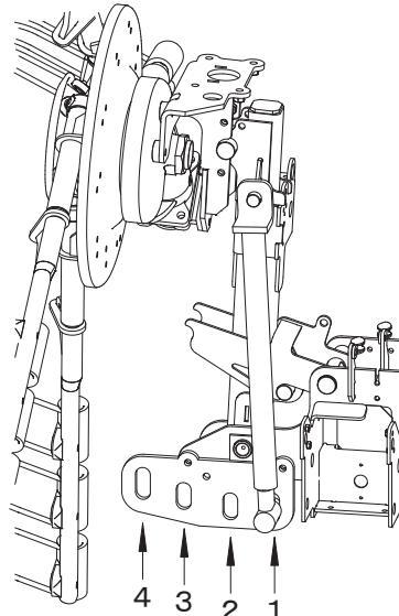
プリセットロッドの差し替えは、ロータを完全に折りたたんでロックがかかっている状態で行い、プリセットロッド端部のワッシャとリングピンを確実に取付けてください。
