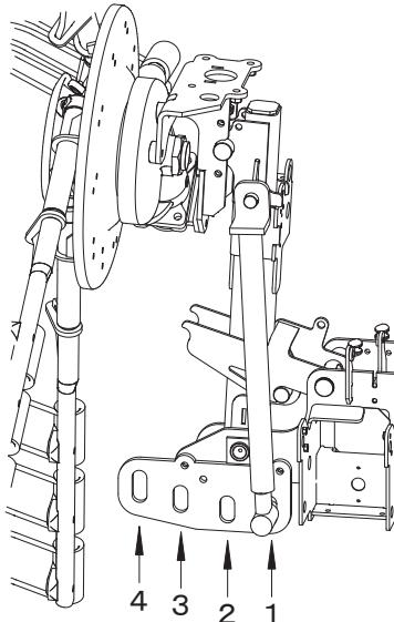
プリセットロッドの差し替えは、ロータを完全に折りたたんでロックがかかっている状態で行い、プリセットロッド端部のワッシャとリンチピンを確実に取付けてください。
