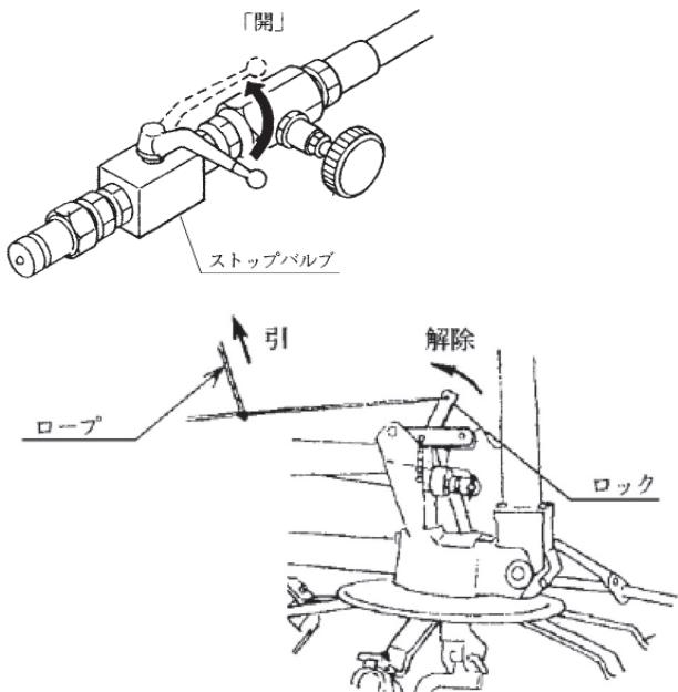
2. トラクタ油圧（外部取出）を操作し、ロータを広げてください。
