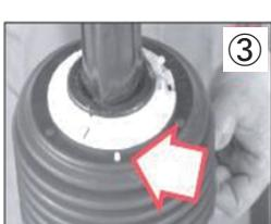
③ アウターコーンを取り付、コーンの穴にベアリングリングの基準ピンを挿入します。
