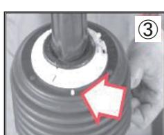
③ オウターコーンを取り付け、コーンの穴にベアリングリングの基準ピンを挿入します。
