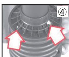
④ ベースコーンをチューブに取り付け、コーンの穴に基準ピンとベアリングリングのグリースニップルを挿入します。
