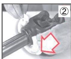
② 基準ピンをドライブチューブに向けて、ベアリングリングを溝に取り付けます。
