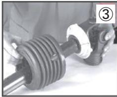
③ アウターコーンとベアリングリングを取り外します。
