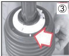
③ アウターコーンを取り付け、コーンの穴にベアリングリングの基準ピンを挿入します。
