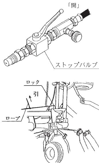
2. トラクタ油圧（外部取出）を操作し、ロータをあげてください。
