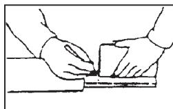
(3) パイプのアウタとインナ両方を金ノコまたはカッターで切断します。切断するときは、パイプの中にウエスを詰め、切り粉がパイプ内面に付着するのを防いでください。
