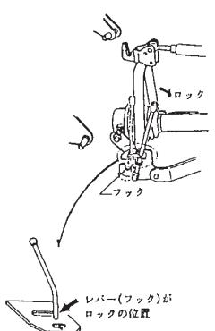
(10) P I C軸芯がトラクタ中心におおよそ一致するようにチェックチェーンでセットして作業機の横振れをなくしてください。
