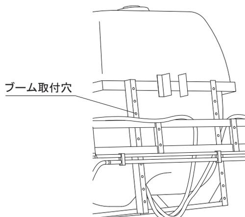
正しいブーム高さは、噴霧対象上において隣接するノズルより噴霧される薬液の重なりが50%となる高さで、およそ35cmとなります。なお、最終的な微調整はトラクター3点リンクの高さ調整で行います。
