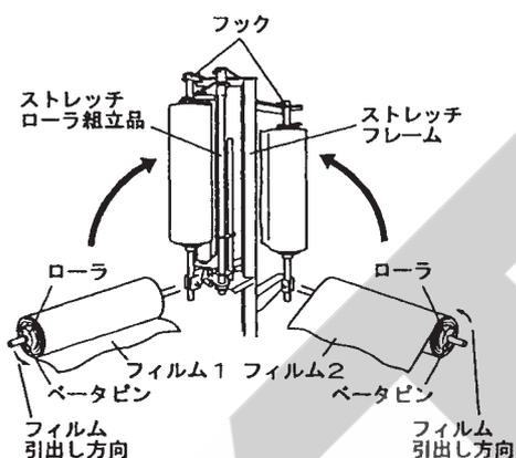
(4) フィルムは、巻き方向が上から見て反時計方向になるよう挿入し、フィルム1とフィルム2を重ねストレッチローラに通します。
