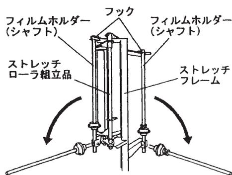
(3) フィルムホルダー（シャフト）より、ベータピン・ローラを抜き取りフィルムを挿入します。フィルム挿入後、ローラ・ベータピンを挿入し、上方に押し上げ、フィルムホルダ（シャフト）上部でストレッチフレーム上部フックと固定します。
