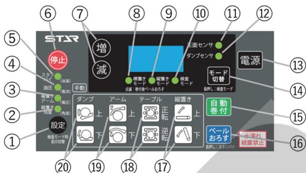
1. ②「ダンプ上」スイッチを押してターンテーブルを上昇させてください。ターンテーブルがフレームに接地し、⑫「ダンプセンサ」が点灯することを確認してください。
