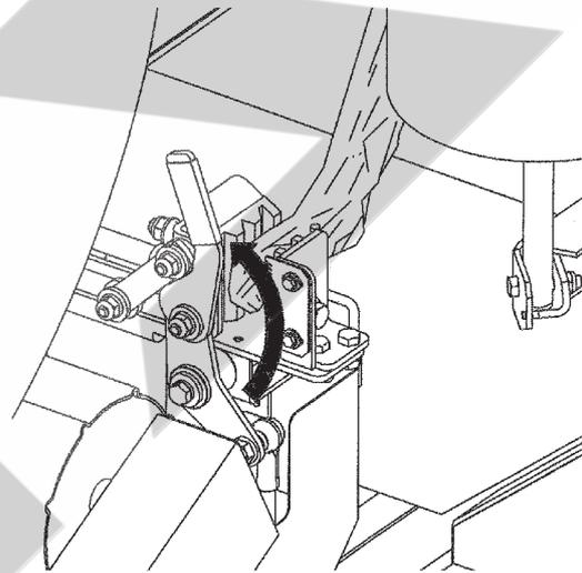
※ フィルムをラップホルダ部にセットする工程は、フィルムを新規に組込み挿入したときのみ行います。ラッピング作業時は、フィルム巻き付け荷降ろし時に、ラップホルダ部で自動的にフィルムを保持し、次のラッピング作業が行えます。
