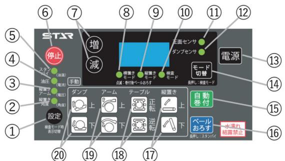
本製品のソウサボックスは、「巻数」、「縦置き角度」、「縦置きアーム」、「油圧」、「スタンバイ」、「縦置きモード」、「横置きモード」、「検査モード」の設定ができます。
