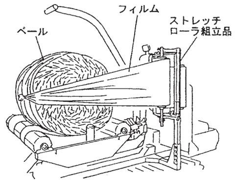
※ フィルムをベール側トワインに結びつける工程は、フィルムを新規に組み込み挿入したときのみ行います。
