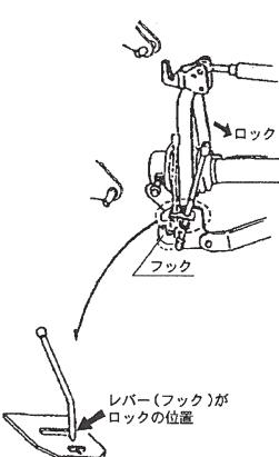
(10) PIC軸芯がトラクタ中心におおよそ一致するようにチェックチェーンでセットし、作業機の横振れをなくしてください。
