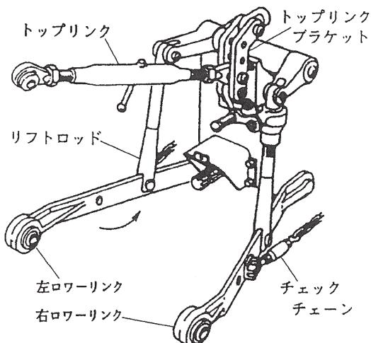
特殊3点リンク式のロータリを使用している場合には、トップリンクの連結部を外し、標準3点リンク用の長いトップリンクを使用してください。
