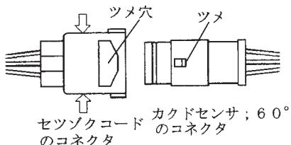
(6) セツゾクコードの2Pコネクタ（T字、コード色白・黒）とコード；3500（電源コード）またはトラクタ内の電源を取り付けてください。
