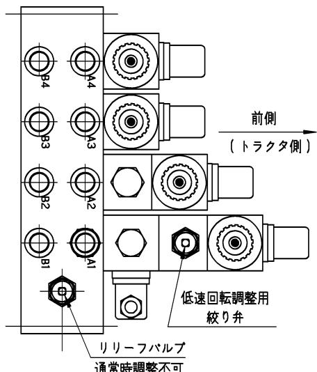
低速回転調整用の絞り弁は、時計回りに締める
