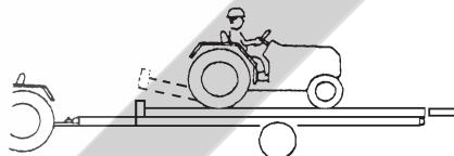
(11) 完全に水平になったら、10~20 cm ドローバ側に移動し停止してください。
