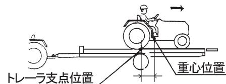
(8) 積載したトラクタやコンバインの重心位置がトレーラの荷台支点位置を越えると、ボディが傾斜しはじめます。
