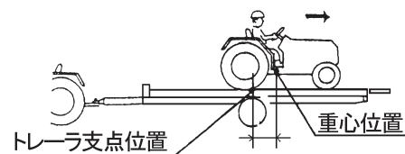
(8) 積載したトラクタやコンバインの重心位置がトレーラの荷台支点位置を越えると、ボディが傾斜しはじめます。
