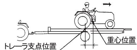
(8) 積載したトラクタやコンバインの重心位置がトレーラの荷台支点位置を越えると、ボディが傾斜しあげます。
