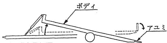
※ ボディ水平：ボディが水平になりますと運動してアユミが上がり、運搬状態になります。
