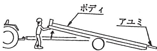
(6) ボディの傾斜が足りない場合、ボディの後方に乗るなどの補助をしてください。
