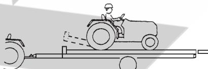
(11) 完全に水平になったら、10~20cmドローバ側に移動し、停止してください。
