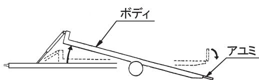
※ ボディ水平：ボディを平にし、アユミを上げた状態で、運搬状態になります。
