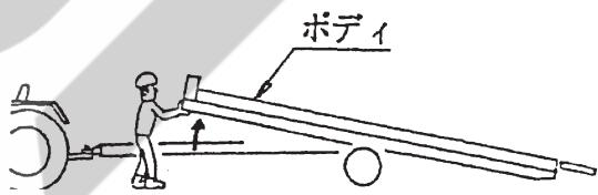
(7) ボディの傾斜が足りない場合、ボディの後方に乗るなどの補助をしてください。
