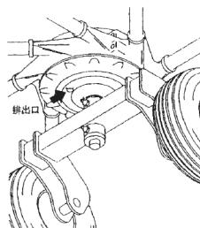
給油はオイルジョッキで計量後、指定の量を給油してください。ロータを水平においたとき、給油口がオイルレベル穴になっています。ロックカクプラグはシールテープを巻付け、取付けてください。
