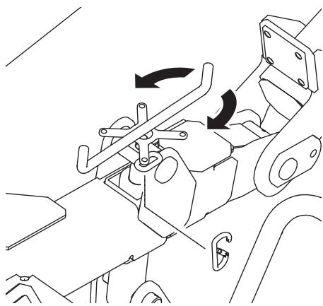
2. アジャスター (調整側) を回転させタインが地上から 10 ~ 20 mm になるように調整します。
