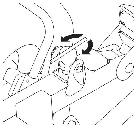
3. タイン地上高調整後、アジャスター (固定側) を回転させ、アジャスターとフレームの穴位置を合わせてピンを入れてください。
