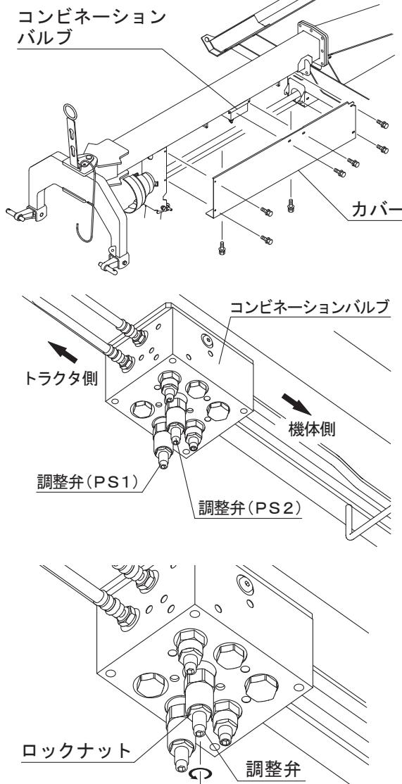
調整弁(PS2)だけ調整してください。
