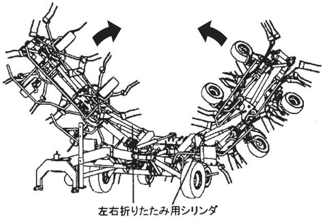
(4) 左右ロータを折りたたんだ後、ロータ部を前方に倒れます。
