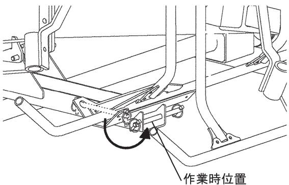
ストッパーのピンを作業時位置に差し替えてから油圧操作を行ってください。
