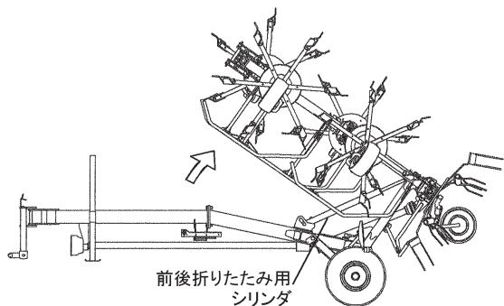
3. 前後折りたたみ用シリンダが最大まで伸びた後、左右折りたたみ用シリンダが伸びてロータが広がります。
