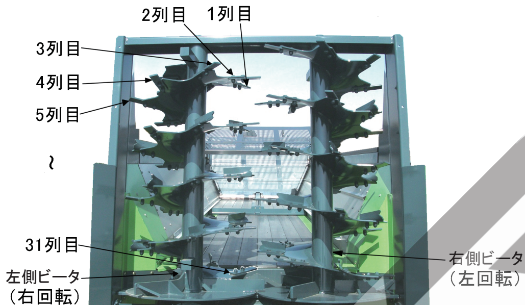
ブレード配列最上部より
