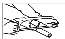
切断するときは、パイプの中にウエスを詰め、切り粉がパイプ内面に付着するのを防いでください。
