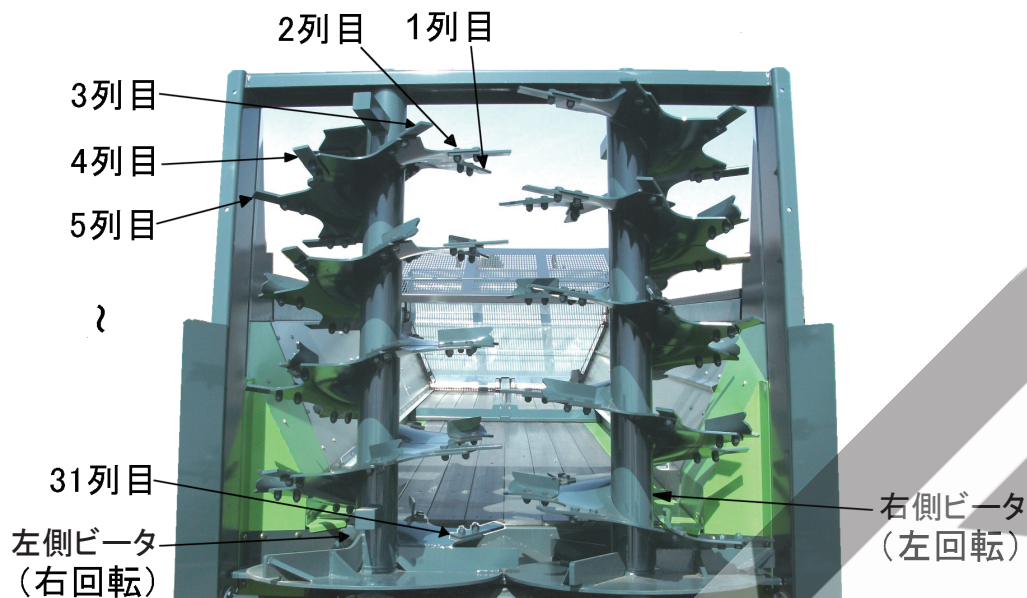
ブレード配列最上部より
