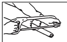
切断するときは、パイプの中にウエスを詰め、切り粉がパイプ内面に付着するのを防いでください。
