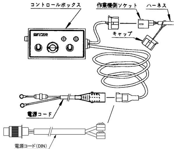
本機には、バッテリーから直接電源を取る電源コードに加え、DIN規格電源コードが付属しています。マッチングするトラクタの種類に合わせて使用する電源コードを選択してください。
