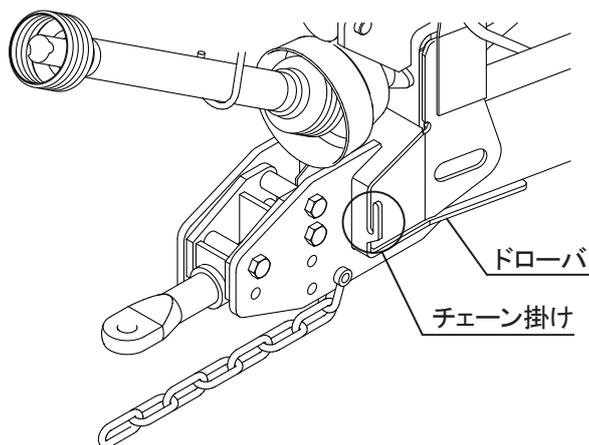
9. 作業機のスタンドを立て、ヒッチカンがトラクタのドロバから浮き上がるまで、スタンドハンドルを回してください。
