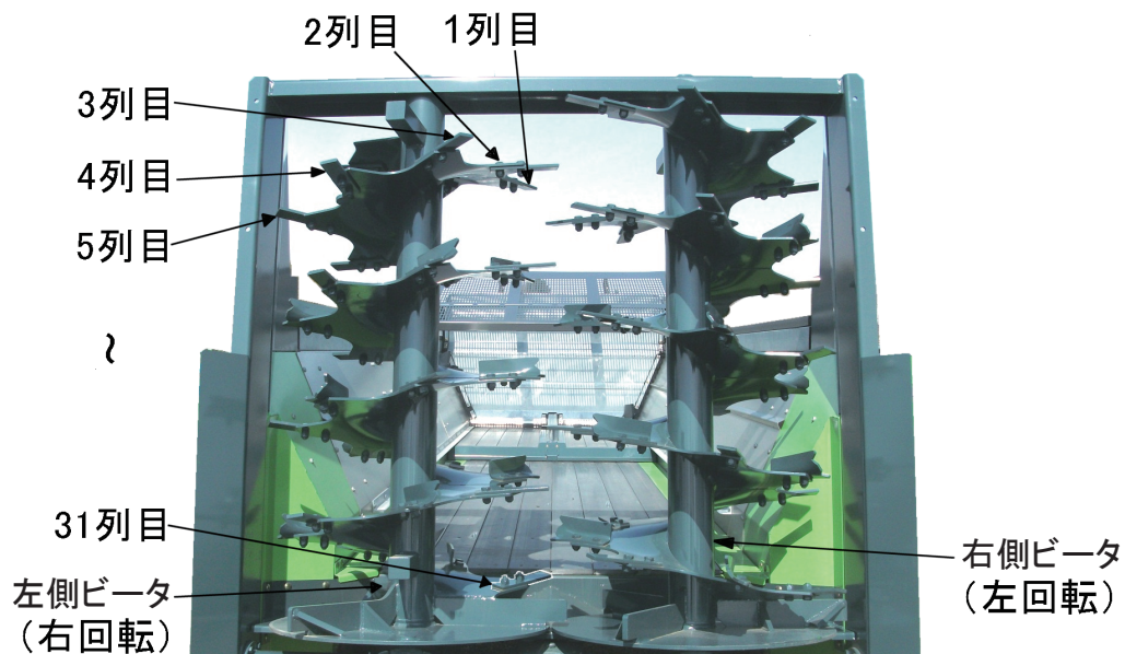
ブレード配列最上部より
