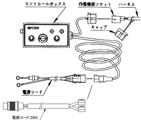
本機には、バッテリーから直接電源を取る電源コードに加え、DIN規格電源コードが付属しています。マッチングするトラクタの種類に合わせ使用する電源コードを選択してください。
