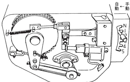
チェンジレバーを希望変速位置溝までスライドさせ、レバーをたおし、溝にはめこむと、変速操作は完了します。
