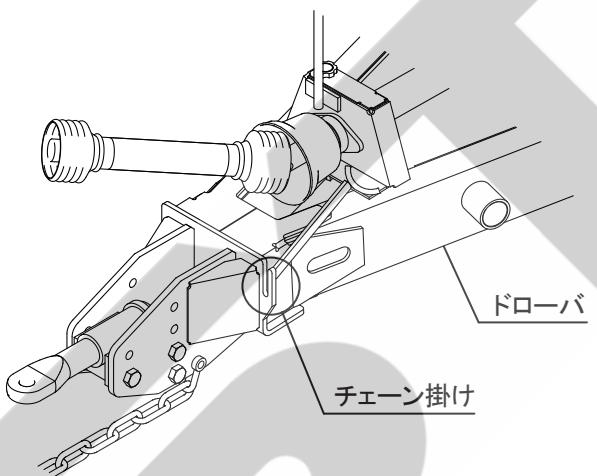
9. 作業機のスタンドを格納時位置からスタンド使用時位置へと移動させ、ヒッチカンがトラクタのドローバから浮き上がるまで、スタンドハンドルを回してください。
