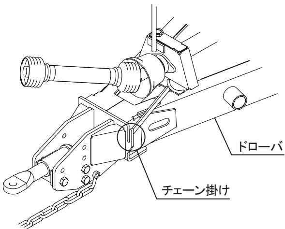
9. 作業機のスタンドを格納時位置からスタンド使用時位置へと移動させ、ヒッチカンがトラクタのドローバから浮き上がるまで、スタンドハンドルを回してください。
