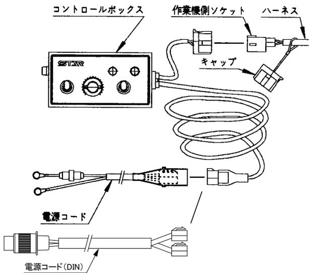
本機には、バッテリーから直接電源を取る電源コードに加え、DIN規格電源コードが付属しています。マッチングするトラクタの種類に合わせて使用する電源コードを選択してください。
