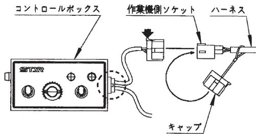
コントロールボックスから作業機側ソケットを外すときは、矢印部分を押しながら外してください。
