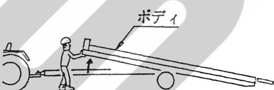
(7) ボディの傾斜が足りない場合、ボディの後方に乗りなどの補助をしてください。
