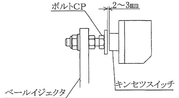
ベールイジェクタのボルトの高さを調節して、キンセツスイッチとのすき間を2~3mmに調節してください。
