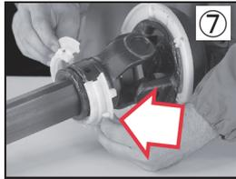
⑦ インナーヨークのベアリング溝にグリースを塗り、基準ピンをドライブチューブに向けて、ベアリングリングを溝に取り付けます。
