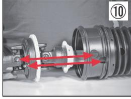
⑩ カバーの穴をベアリングリングの基準ピンに合わせ、下部の穴を小さいベアリングリングの基準ピンに合わせてカバーを挿入します。このとき、グリースニップルをカバーの穴に合わせてください。
