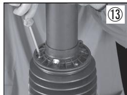
⑬ プラスネジを締めます。電動ドライバーは使用しないでください。
