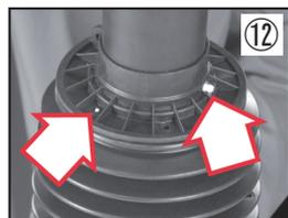
⑫ ベースコーンをチューブに取り付け、コーンの穴に基準ピンとベアリングリングのグリースニップルを挿入します。
