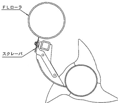
スクレーパーへの取り付けは下図の位置に取り付けてください。
