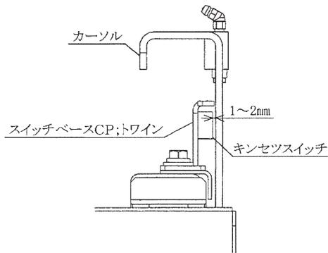
トワインバインディングのキンセツスイッチは、キンセツスイッチとカーソルのすき間を平行に1~2mmになるようにスイッチベースCP;トワインを位置調整します。
