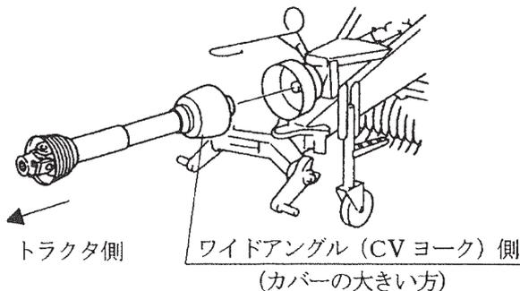
(2) 安全カバーのチェーンを固定した所に取り付け、カバーの回転を防いでください。チェーンは3点リンクの動きに順応できる余裕を持たせ、また他へのひっかかりなどが無いように余分なたるみを取ってください。
