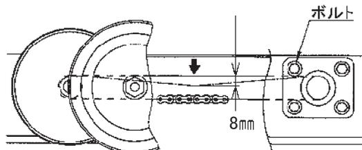
張りの強さはローラチェーンの中央部を指で押してたわみ量が8mmになるのが適正です。
