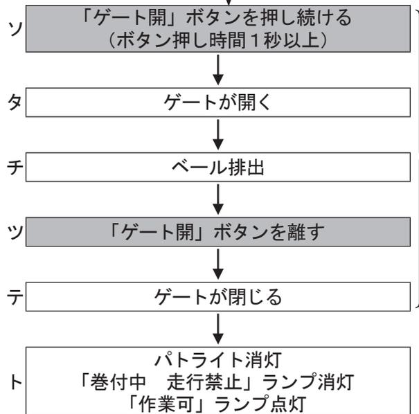
※5「巻付中 走行禁止」ランプが点滅し、ブザーが鳴り（カンケツ音 ピー、ピー、ピー、…）ゲートが自動で閉じる場合はベール排出不良を示しています。一度、電源ボタンを押して電源を切り、再度、電源を入れます。本機横のゲート開ボタンを押してゲートを開き、ストップバルブを閉じてゲートが閉まらない事を確認し、トラクタのPTO、エンジン、ソウサボックスの電源を切ります。その後、ロールベアラ内よりベールを引き出します。ベール排出後、ストップバルブを開きゲートを閉じ作業を始めてください。
