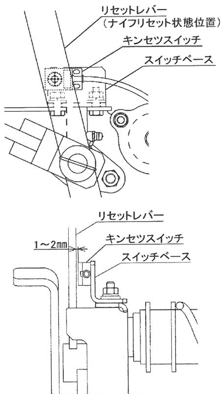
ネットバインディングのキンセツスイッチは、リセットレバーとのすき間を1~2mmに調整してください。調整はナイフリセット状態位置で行ってください。
