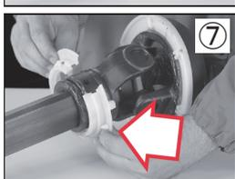
⑦ インナーヨークのベアリング溝にグリースを塗り、基準ピンをドライブチューブに向けて、ベアリングリングを溝に取り付けます。
