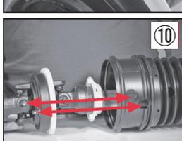
⑩ カバーの穴をベアリングリングの基準ピンに合わせ、下部の穴を小さいベアリングリングの基準ピンに合わせてカバーを挿入します。
