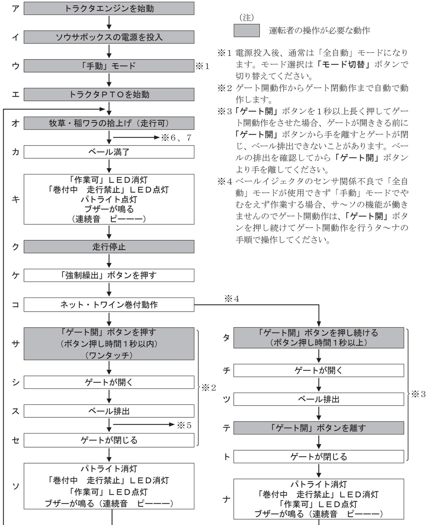
※5 表示部に番号「10」が点滅し、ブザーが鳴り(間欠音 長ピー、ピー、ピー、・・・) ゲートが自動で閉じる場合はベール排出不良を示しています。本機横の「**ゲート開**」ボタンを押しゲートを開き、ストップバルブを閉じてゲートが閉まらない事を確認し、トラクタのPTO、エンジン、ソウサボックスの電源を切ります。その後、ロールベアラ内よりベールを引き出します。ベール排出後、ストップバルブを開きゲートを閉じ作業を始めてください。
