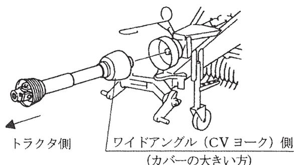
(2) 安全カバーのチェーンを固定した所に取り付け、カバーの回転を防いでください。
