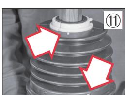
⑪ カバーとベアリングリングの基準ピンが穴に合っていて、基準ピンがきちんと挿入されていることを確認します。
