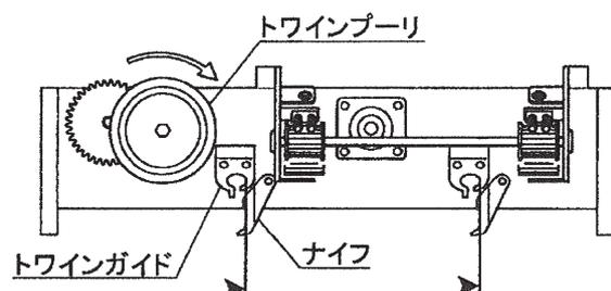
(4) トワインAの始端部を1～7の順序で、トワインCの始端部を①～⑥の順序で通します。
