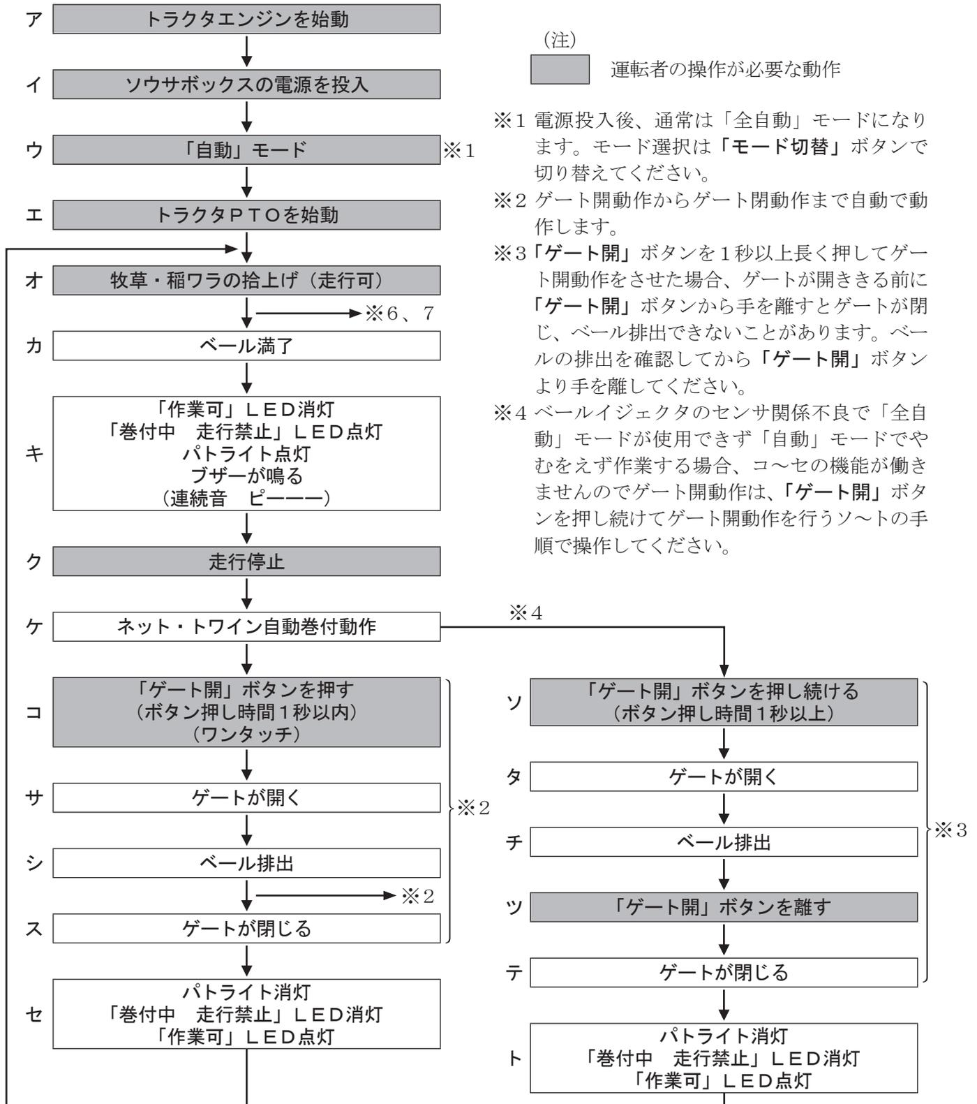
※5 表示部に番号「10」が点滅し、ブザーが鳴り（間欠音 長ピー、ピー、ピー、・・・）ゲートが自動で閉じる場合はベール排出不良を示しています。本機横の「ゲート開」ボタンを押しゲートを開き、ストップバルブを閉じてゲートが閉まらない事を確認し、トラクタのPTO、エンジン、ソウサボックスの電源を切ります。その後、ロールベアラ内よりベールを引き出します。ベール排出後、ストップバルブを開きゲートを閉じ作業を始めてください。
