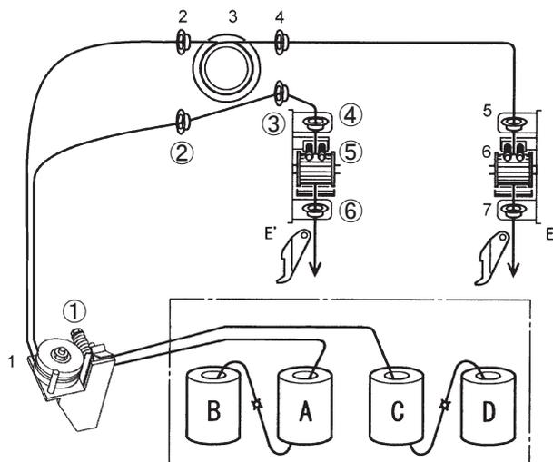
(5) トワインA、Cの始端部をバイディングナイフE・E'で切り、トワイン先端は、ナイフプレートに保持させてください。
