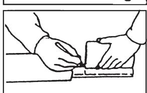
(3) パイプのアウタとインナ両方を金ノコまたはカッターで切断します。切断するときは、パイプの中にウエスを詰め、パイプ内面に切り粉が付着するのを防いでください。
