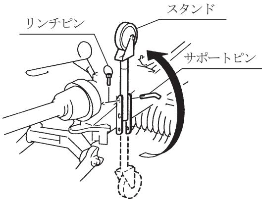
(7) 作業機の姿勢が水平になるように、トラクタローワーリンクを調整してください。ロワーリンクブラケット支点のピンの地上高が 460mm になるのが標準です。
