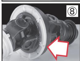
⑧ C V ヨークのベアリング溝にグリースを塗り、基準ピンを内側に向けて、ベアリングリングを溝に取り付けます。
