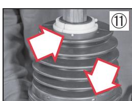
⑪ カバーとベアリングリングの基準ピンが穴に合ってい、基準ピンがきちんと挿入されていることを確認します。カバー固定のプラスネジを締めます。
