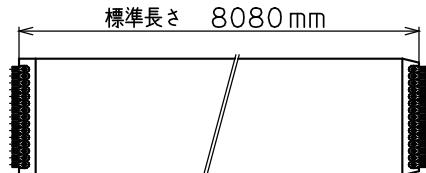
レーシングピンは2000個包毎に交換してください。ベルト交換が終了後「5-3-11 ベルトアライメントの調整」の説明に基づき調整してください。
