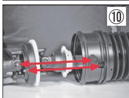
⑩ カバーの穴をベアリングリングの基準ピンに合わせ、下部の穴を小さいベアリングリングの基準ピンに合わせてカバーを挿入します。このとき、グリースニップルをカバーの穴に合わせてください。
