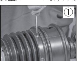
① CVコーンのプラスネジを取り外します。
