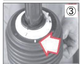
③ ウターコーンを取り付、コーンの穴にベアリングリングの基準ピンを挿入します。
