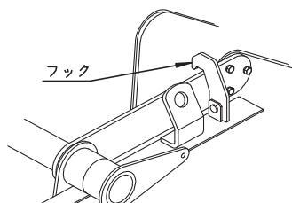
(2) トラクタをアイドリング状態で外部油圧を操作します。ゲートが1/4程度開いたところでストップバルブを閉じます。
