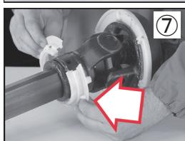
⑦ インナーヨークのベアリング溝にグリースを塗り、基準ピンをドライバチューブに向けて、ベアリングリングを溝に取り付けます。
