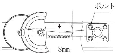
張りの強さはローラチェーンの中央部を指で押してたわみ量が8 mmになるのが適正です。
